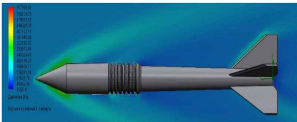
Рис. 4. Розподіл тиску повітряного потоку, що створюється при польоті БМ-9
