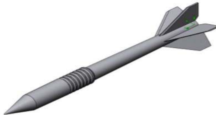
Рис. 3. Бронебійний підкаліберний снаряд БМ-9
