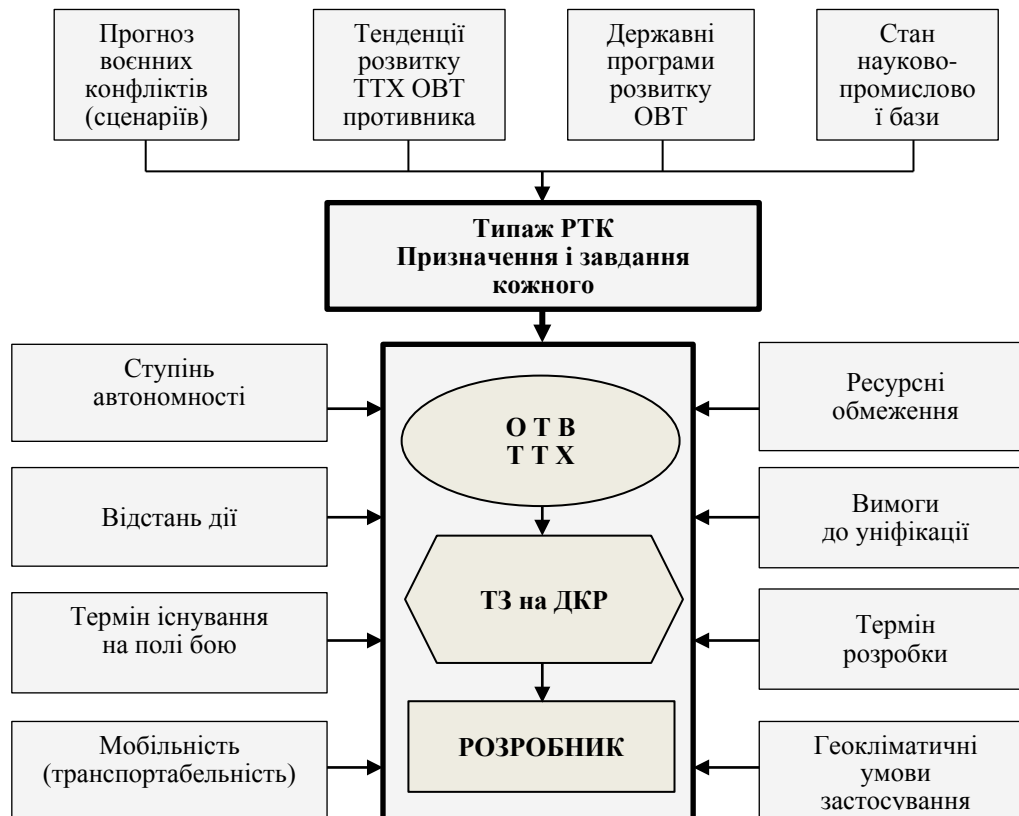
Рис. 1 – Фактори, що обумовлюють формування ОТВ до робототехнічних комплексів (вихідні дані до розробки ОТВ)
