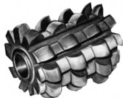
Рис. 5. Зовнішній вигляд чистової черв'ячної фрези з кутом підйому 18^\circ 22'
