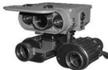
Рис. 4. Оптико-електронні пристрої виявлення оптичних приладів
