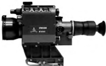
Рис. 6. Оптико-електронний прилад «Антиснайпер»
